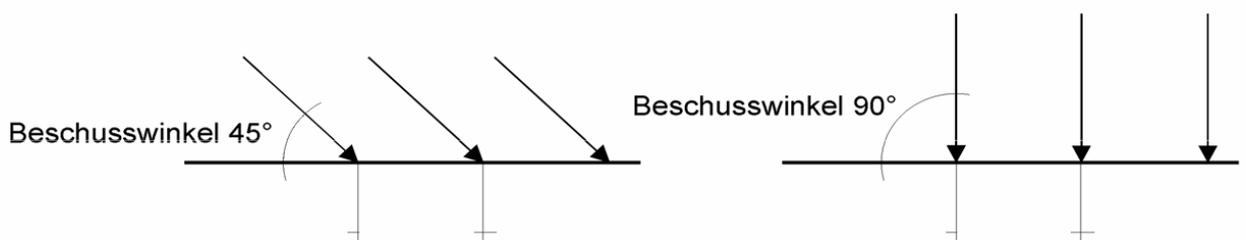
Abbildung 2 Beschusswinkel der Holzteile (Seitenriss, Masse in Millimeter)
