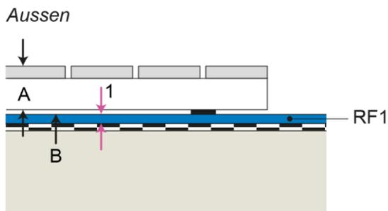
Terrassenboden auf Bedachung mit brennbarer oberster Schicht
