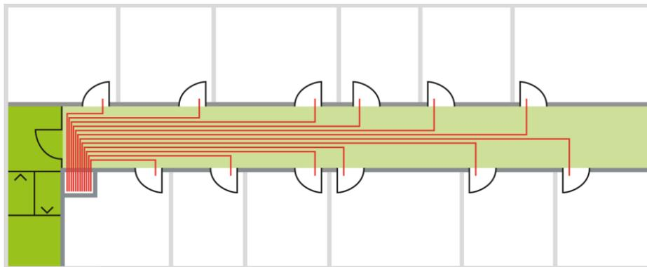
Die Summe der im horizontalen Fluchtweg vorhandenen Brandlast aus Kabeln geteilt durch die Länge des horizontalen Fluchtweges darf maximal 200 MJ/Laufmeter betragen. Örtlich sind höhere Werte zulässig.
