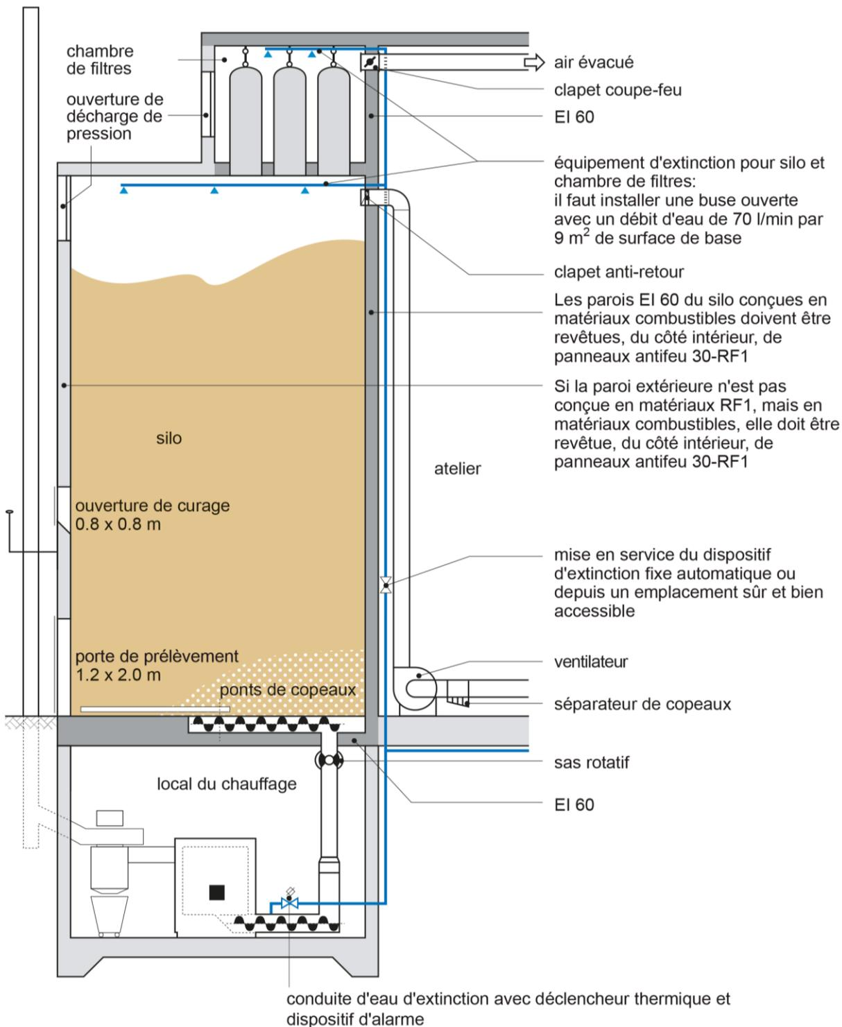
Panneau antifeu 30-RF1 = panneau antifeu avec 30 minutes de résistance au feu en matériaux de construction RF1.
