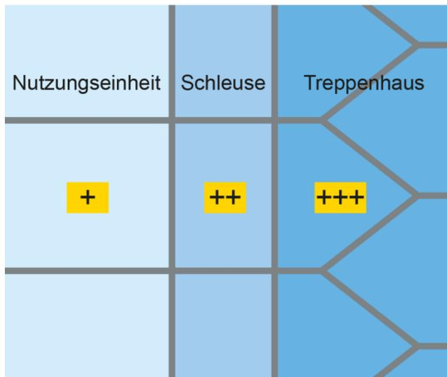
RDA mit Druckkaskade vom Treppenhaus zur Nutzungseinheit
