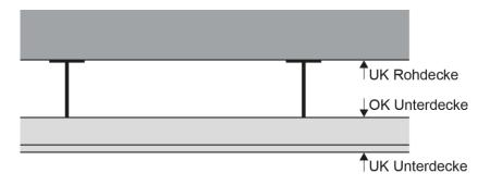
Keine Brandmelder unterhalb Doppelboden, wenn Höhe von Oberkant Doppelboden bis Oberkant Rohboden ≤ 0.2 m:
