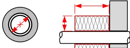
Il s'agit des dimensions minimales et maximales autorisées. Les informations détaillées concernant le domaine d'application des tuyaux en plastique et des isolations de tuyauterie se trouvent dans les attestations d'essai.
